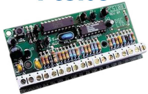
EXPANSOR DE 8 ZONAS CABLEADAS
